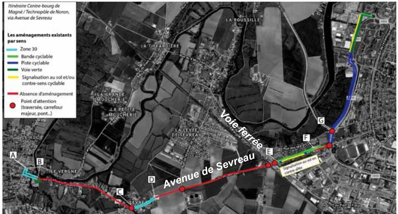
Bilan des aménagements existants et des discontinuités ; Sources : google / SCE
